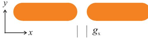
**Abbildung 2.13:** Dimere: Antennenpaare mit wohldefiniertem Abstand  $g_x$  in gängiger Spitze-zu-Spitze Anordnung. Die Abbildung zeigt die Aufsicht eines Dimers bestehend aus zwei zylinderförmigen Nanodrähten.
