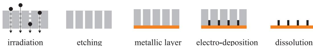
**Abbildung 4.1:** Elektrochemische Materialabscheidung in ionengeätzten Polymerfolien: relevante Präparationsschritte.
