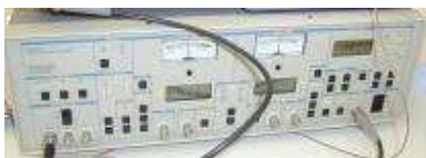
b) Lock-In-Verstärker SR530 von Stanford Research Systems. Es ist ein analoger Zwei-Phasen-Lock-In, d.h. er kann gleichzeitig zwei Signale X (= A \cos \phi) und Y (= A \sin \phi) messen.
