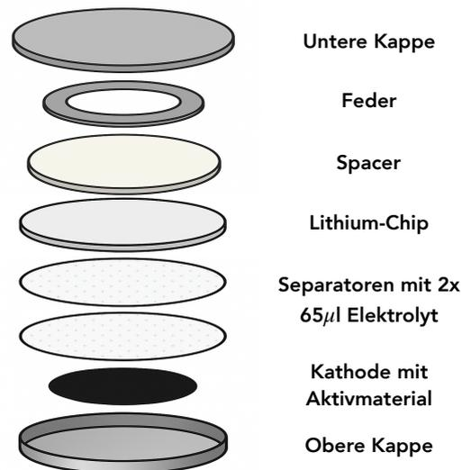
Abbildung 2.1: Schematischer Aufbau einer Knopfzelle, erstellt von OpenAI [18].
