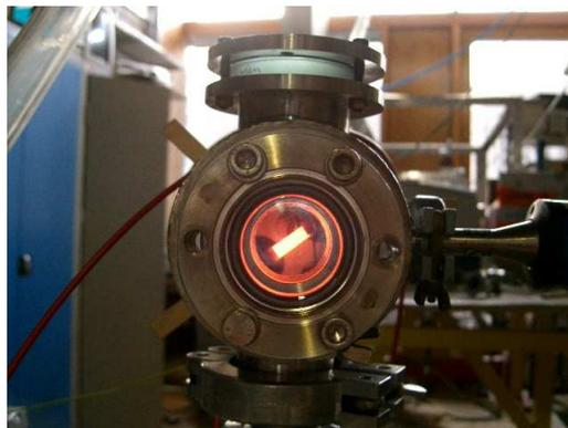
**Abbildung 5.1:** Glühendes Silizium im Vakuum. Eine homogene Stromverteilung führt zu einer homogenen Emission und somit zu einer gleichmässigen Wärmeverteilung.
