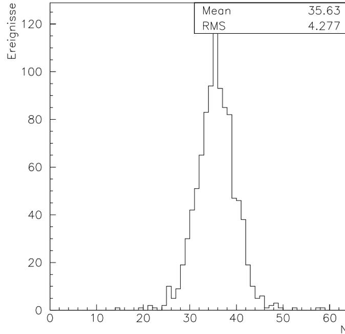
Abbildung 4.27: Verteilung der Anzahl der pro Ereignis über der Rauschschwelle liegenden Kanäle  $N$ . Aufgetragen ist die Anzahl der Ereignisse, die genau  $N$  Kanäle enthalten, die über dem Rauschschnitt liegen, gegen die Anzahl der pro Ereignis über der Rauschschwelle liegenden Kanäle. Mittelwert und quadratische Abweichung der Verteilung vom Mittelwert sind aus der Abbildung zu erkennen.
