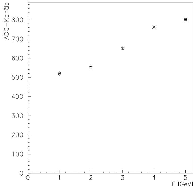
Abbildung 4.28: Linearität der Energiemessung. Aufgetragen ist der Mittelwert der mit dem Kalorimeter aufgenommenen Energieverteilung in ADC-Kanälen, gegen die Einschußenergie der Elektronen in GeV. Die Energieverteilungen sind mit einem Rauschschnitt von  $0.5 \cdot \sigma_{rausch}$  berechnet. Die Fehlerbalken sind kleiner als die zur Darstellung der Punkte verwendeten Symbole.
