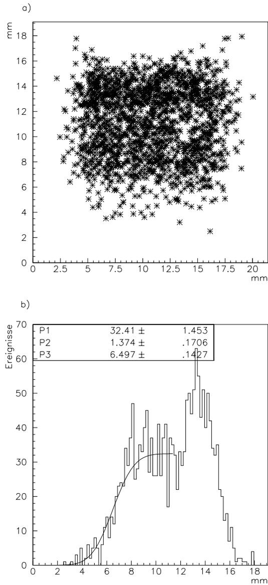
Abbildung 4.22: a) Verteilung der rekonstruierten Orte von Elektronen mit 4 GeV im Kalorimetermodul. b) Projektion von a) auf die y-Achse mit Anpassung der errechneten Kurve aus Gleichung 4.6. Der Parameter P2 entspricht der Ortsauflösung. Der Peak in Teilbild b) kann nur durch eine Inhomogenität im Strahl, die durch vor dem Kalorimeter stehende Detektoren verursacht sein kann, erklärt werden. Das Loch in der Verteilung von Teilbild a) ist durch einen fehlerhaften Kanal verursacht.
