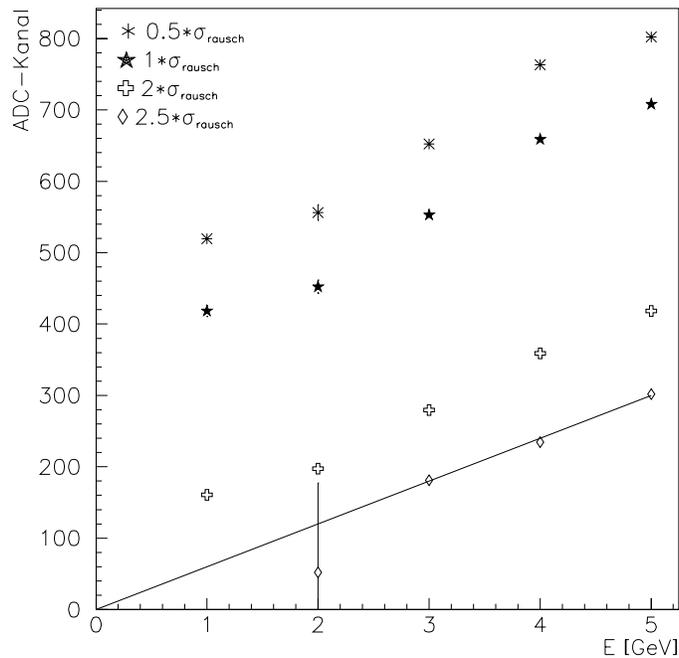
Abbildung 4.29: Mittelwerte von Energieverteilungen mit unterschiedlichen Rauschschnitten aufgetragen gegen die Einschussenergie. Die zum jeweiligen Rauschschnitt gehörigen Punkte sind in der Abbildung gekennzeichnet. Für einen Rauschschnitt von  $2.5 \cdot \sigma_{\text{rausch}}$  arbeitet das Kalorimeter linear. Bei den Punkten ohne Fehlerbalken sind die zur Darstellung der Punkte verwendeten Symbole größer als diese.
