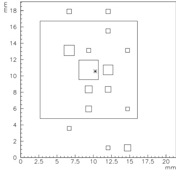
Abbildung 4.7: Dasselbe Ereignis wie in der vorigen Abbildung, jedoch mit eingezeichneter Berechnungsmaske und berechnetem Schwerpunkt. Es sind nur Kanäle eingezeichnet und bei der Berechnung berücksichtigt, die über  $1.5 \cdot \sigma_{rausch}$  liegen.
