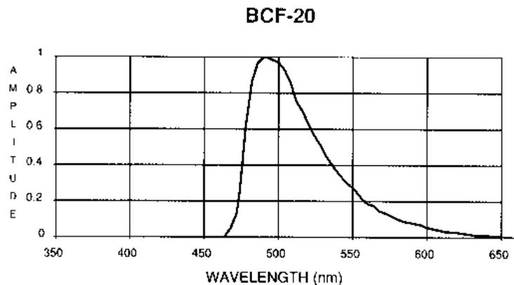
Abbildung 3.3: Emissionsspektrum der Fasern von Typ BCF-20 der Firma Bicon. [Bic94]
