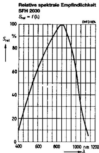
Abbildung 3.4: Relative spektrale Empfindlichkeit der Photodiode. [Sie]
