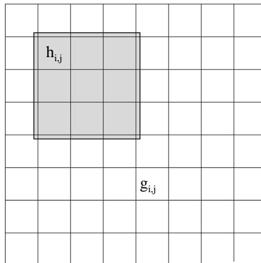
Abbildung 4.17: Prinzip einer Glättungsoperation. Um jeden Bildpunkt in der Pixelmatrix wird eine Maske von Gewichtungsfaktoren  $h_{i,j}$  gelegt, die grau eingefärbt ist. Anschließend werden die Bildeinträge  $g_{i,j}$  in der Maske mit dem entsprechenden Gewichtungsfaktor multipliziert und alle Ergebnisse der Multiplikationen in der Maske addiert. Der sich ergebende Wert wird dann an das zentrale Pixel zurückgeschrieben.
