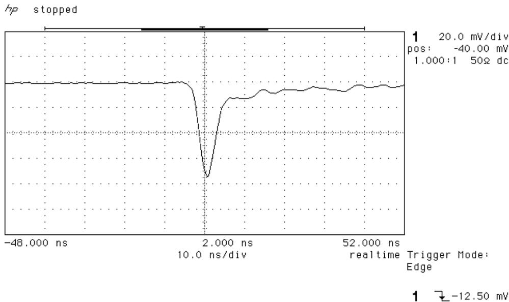
Abbildung A.2: Das Lichtsignal des Pulsers mit einem Photomultiplier gemessen.
