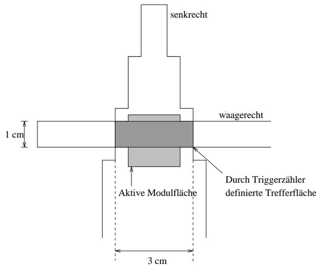
Abbildung 4.2: Anordnung der Triggerzähler in Strahlrichtung gesehen
