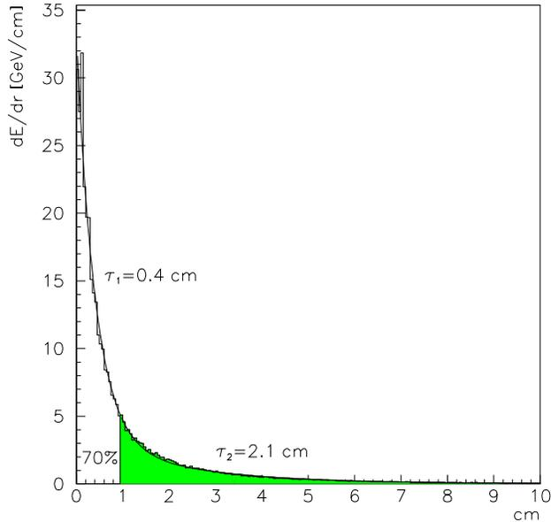
Abbildung 4.5: Simuliertes Schauerprofil von Elektronen mit 4 GeV Energie. Aufgetragen ist die Energie, die in einem Ring der Breite  $dr$  im Abstand  $r$  vom Auftreffpunkt deponiert ist, gegen den Abstand  $r$  vom Auftreffpunkt. Es ist eine Funktion der Form  $k_1 \cdot \exp(-x/\tau_1) + k_2 \cdot \exp(-x/\tau_2)$  angepaßt. Die Ergebnisse der angepaßten Parameter  $\tau_1$  und  $\tau_2$  sind aus der Zeichnung ersichtlich.
