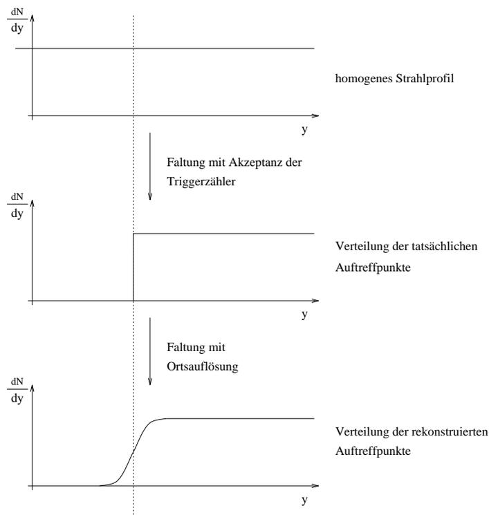
Abbildung 4.21: Entstehung der im Modul registrierten Verteilung der Auftreffpunkte in der Projektion auf die y-Achse. Aufgetragen ist jeweils die Anzahl der Auftreffpunkte pro Ortsintervall  $\frac{dN}{dy}$  gegen den Ort  $y$ .
