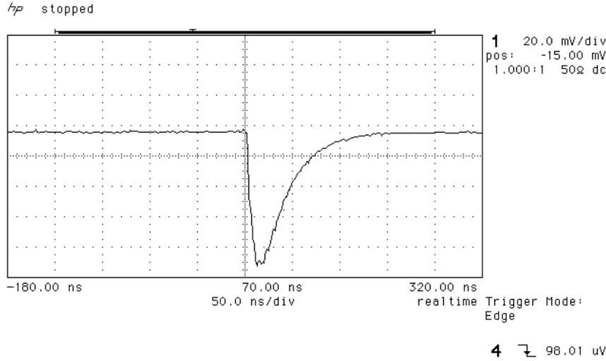
Abbildung A.4: Ausgangssignal des Vorverstärkers. Der Anstieg des Signals ist durch die Bandbreite des Operationsverstärkers gegeben. Der Abfall stellt die Entladung der Kapazität C1 über den Widerstand R1 dar.
