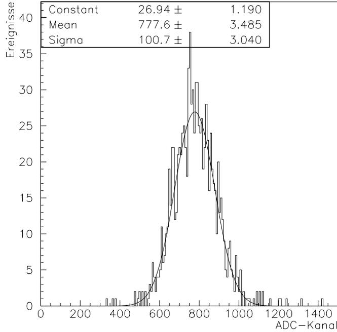
Abbildung 4.26: Energieverteilung von Elektronen mit 4 GeV Energie. Der gemessenen Verteilung ist eine Gaußkurve angepaßt. Die aus der Anpassung extrahierten Parameter der Gaußkurve sind aus der Abbildung ersichtlich.
