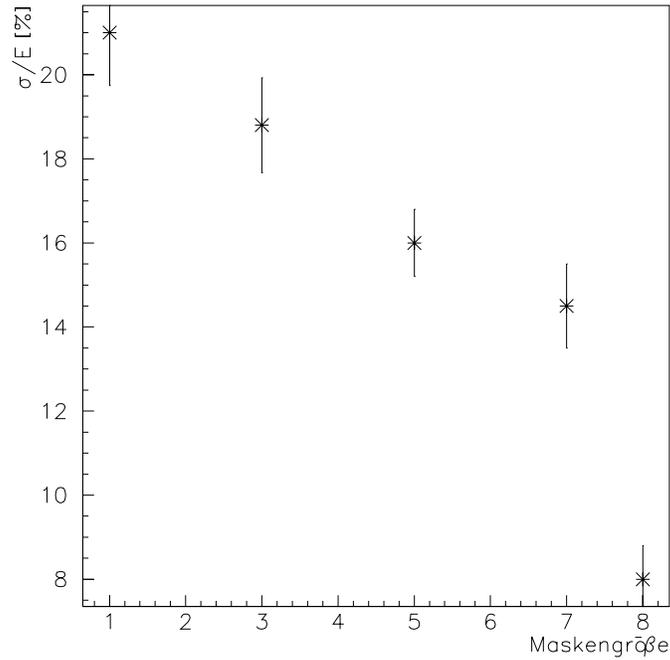
Abbildung 4.25: Energieauflösung in % als Funktion der Maskengröße in *Kanäle x Kanäle*. Beim x-Wert 8x8 Kanäle wird als Berechnungsmaske das ganze Modul benutzt. Zu beachten ist der unterdrückte Nullpunkt auf der y-Achse.
