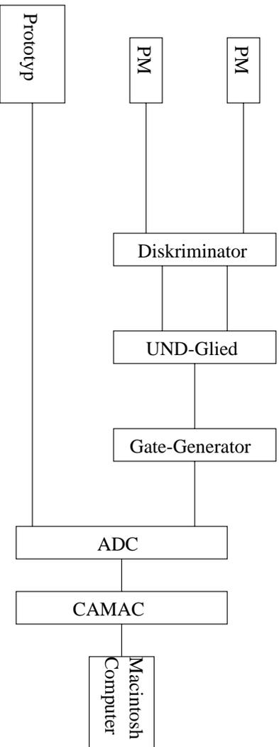
Abbildung 4.3: Ausleseelektronik am Teststrahl
