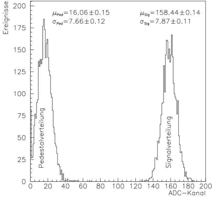
Abbildung 3.10: ADC-Spektren des Vorverstärkers. Der linke Peak ist das Spektrum bei Dunkelheit und entspricht dem Rauschen des Vorverstärkers. Der rechte Peak entspricht dem Spektrum bei Beleuchtung mit der Referenzlichtquelle. Es sind jeweils die Ergebnisse für den Mittelwert  $\mu$  und die Standardabweichung  $\sigma$  aus der Anpassung einer Gaußkurve an die gemessenen Spektren zu sehen.
