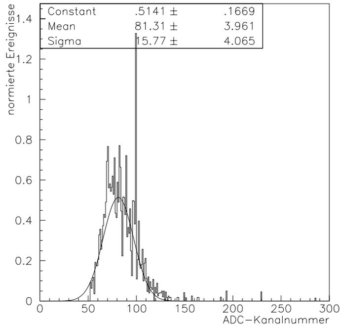
Abbildung 4.24: Addition aller normierten Histogramme für alle Kanäle mit genügend Statistik. Den Meßwerten ist eine Gaußkurve angepaßt. Die aus der Anpassung gewonnenen Parameter sind aus der Abbildung ersichtlich.
