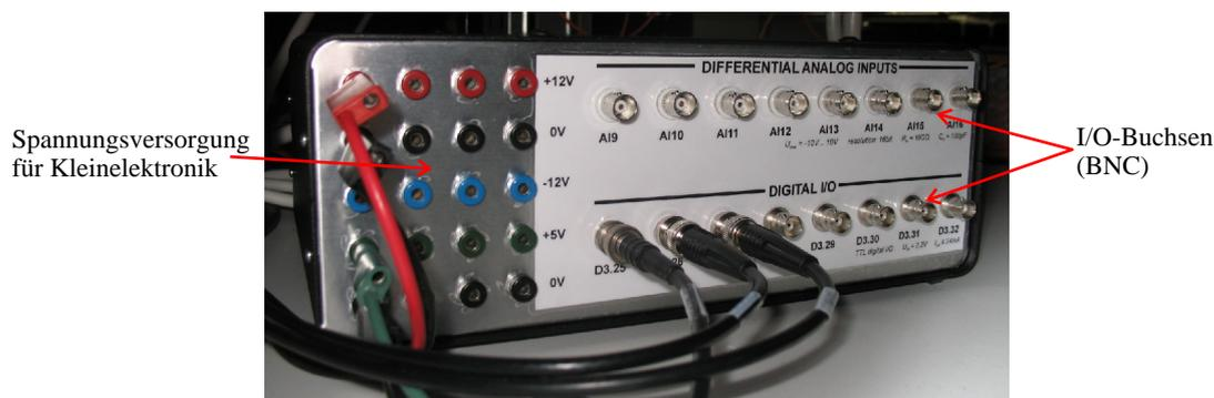
Abb. 6.4. | Foto einer der vier Anschlusskästen.
