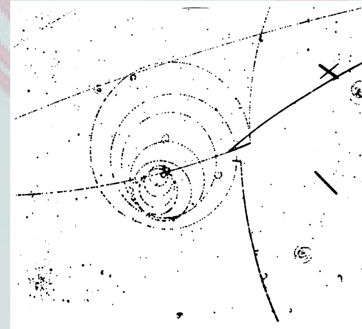
Ausschnitt aus einer Blasenkammeraufnahme des sog. K-Stop Experiments mit der 81-cm Saclay-Blasenkammer am CERN-Synchrotron. Man erkennt die Spur des rechts unten einlaufenden  $K^-$ , welches im flüssigen Wasserstoff abgebremst wird und zur Ruhe kommt, bevor es mit dem Proton des Wasserstoffkerns reagiert:
