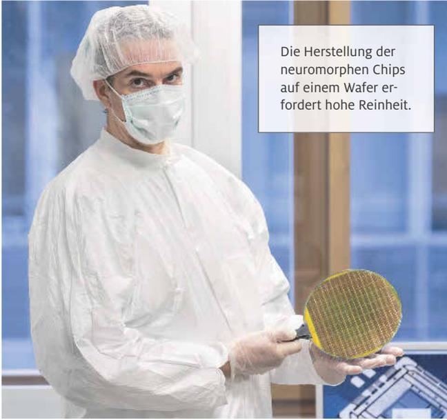
Die Herstellung der neuromorphen Chips auf einem Wafer erfordert hohe Reinheit.
