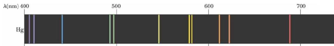
Figure 2: Emissionsspektrum von Quecksilber
