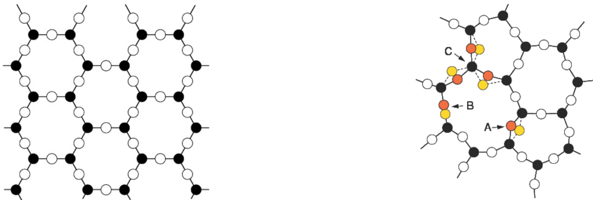
Abb. 2.4: Schematische, zweidimensionale Darstellung von kristallinem (links) und amorphem (rechts) \text{SiO}_2 . Die offenen Kreise stellen Sauerstoff- und die schwarzen Siliziumatome dar. In der amorphen Struktur sind mögliche lokale Konfigurationen gezeigt, die mehrere Gleichgewichtslagen besitzen und somit potentielle Tunnelzustände sind.
