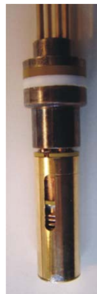
Abb. 3.6: Dilatometer mit induktiver Auslesung. Im linken Teilbild (schematischer Schnitt) ist das Prinzip des Dilatometers dargestellt. Die flüssige Probe wird in den Faltenbalg luftfrei eingefüllt. Die Längenmessung erfolgt mit dem Differentialtransformator am Kopf des Aufbaus. Das rechte Teilbild ist eine Fotografie des Dilatometers (untere Bildhälfte) mit Hochdruckdurchführung (obere Bildhälfte). Die Länge des Dilatometers ist 39.5 mm, sein Durchmesser 13.0 mm.
