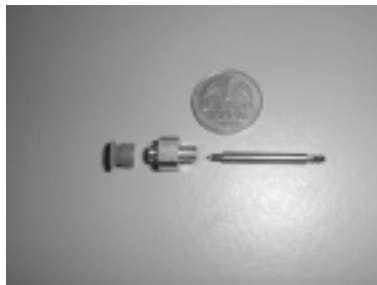
Abbildung 4.4: Aufbau der einzelnen Taxel im Größenvergleich. Man sieht den Saugnapf, die Halterung und den einfachwirkenden Zylinder
