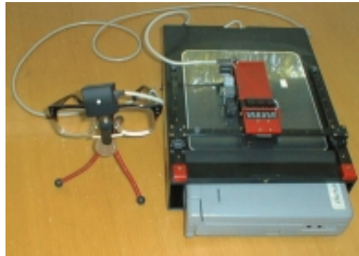
Abbildung 1.4: Das VTD mit einem anderen Projekt HVES 5 [Schmidt-Mende 99]. Das Gerät hat eine Größe von 230 \times 300 \times 300 mm
