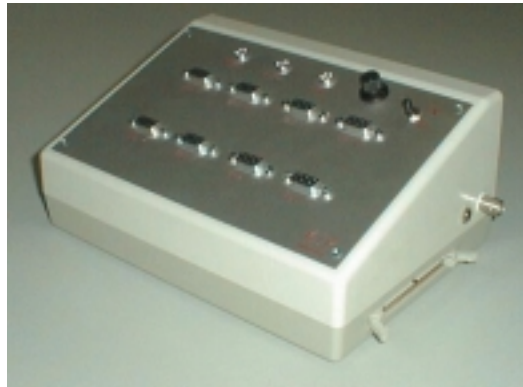
Abbildung 4.12: Steuereinheit mit verbessertem Schaltungsaufbau
