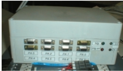
Abbildung 4.6: Die Seitenansicht der elektrischen Steuereinheit zeigt die Abschlüsse für die Ventile
