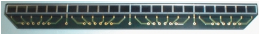
Abbildung 4.5: Ein Foto eines Photodiodenarrays mit 24 Kanälen. Die aktiven Flächen sind als dunkle Rechtecke zu erkennen. Die Photodioden sind durch eine Glasabdeckung von 0.5 mm Dicke geschützt. Der Maßstab der Abbildung ist ungefähr 1:1.
