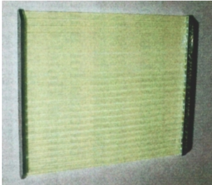
Abbildung 5.9: Eine Fotografie eines fertiggestellten Wellenlängenschieber-Photodioden-Arrays mit 24 Kanälen.
