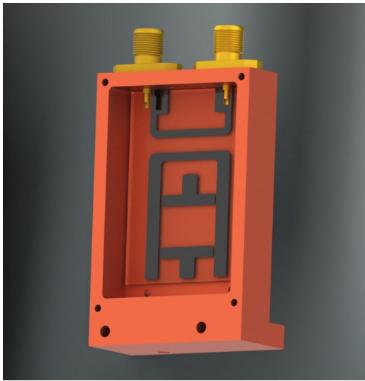
Abbildung 3.4: CAD-Zeichnung des N-BK7 Glases mit Niobstruktur in der Kupferbox ohne Deckel mit SMA-Steckern.
