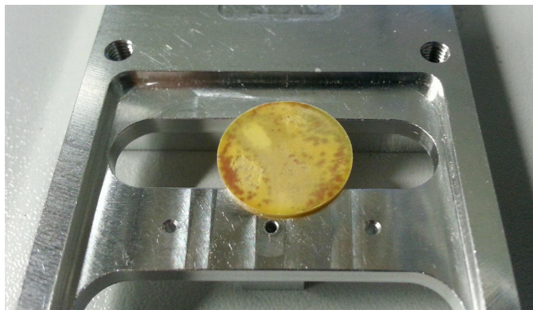
Abbildung 4.3: Foto eines während dieser Arbeit entstandenen KBr-Presslings. Er zeigt klare und trübe Stellen. 0,2 mg des farbigen Chinoxalin-Moleküls genügen, um das weiße KBr zu verfärben.
