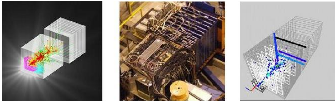
Abbildung 2.13: Hadronen-Kalorimeter: links: Simulation eines Ereignisses in dem Kalorimeter, in der Mitte: Aufbau des Detektorprototyps, rechts: gemessene Daten eines Ereignisses im Kalorimeter [CAL12]
