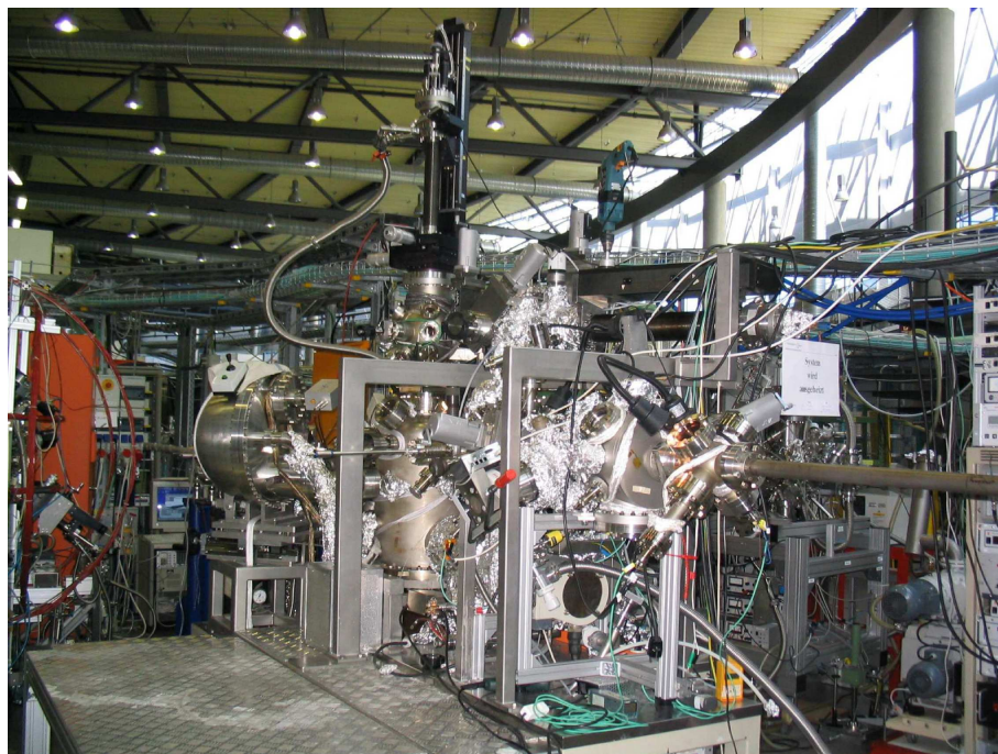
Abbildung 3.18.: Integriertes System SoLiAS bei BESSY: Im vorderen Bereich des Bildes befindet sich die Aufdampfkammer. Nach der Präparation werden die Proben zur Messung in den hinteren Bereich der Anlage transferiert. Zusätzlich kann im oberen Teil des Systems ein Glasdoppelkreuz installiert werden, in dem Proben unter einer Ar-Schutzgasatmosphäre flüssig präpariert werden.
