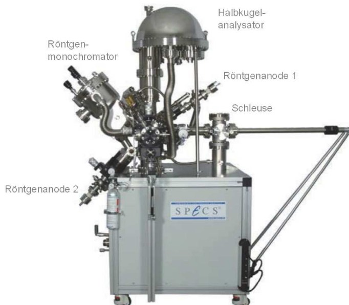
Abbildung 3.2.: Aufbau eines typischen Photoelektronenspektrometers: Als Photonenquelle kann sowohl eine Röntgenröhre als auch eine Heliumgasentladungslampe genutzt werden. Die Photoelektronen werden mit Hilfe eines Halbkugelanalysators energieaufgelöst detektiert. Abbildung entnommen aus [37] und überarbeitet.
