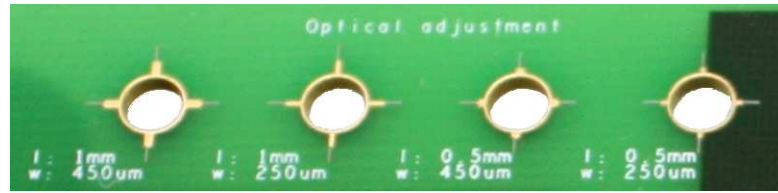
Abbildung 4.5: Testlöcher mit unterschiedlichen Kontaktpads zum Anbringen von Bondrähren
