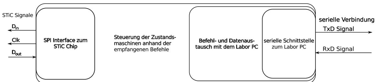
**Abbildung B.1:** Aufteilung der Zustandsautomaten für die Konfiguration des STiC
