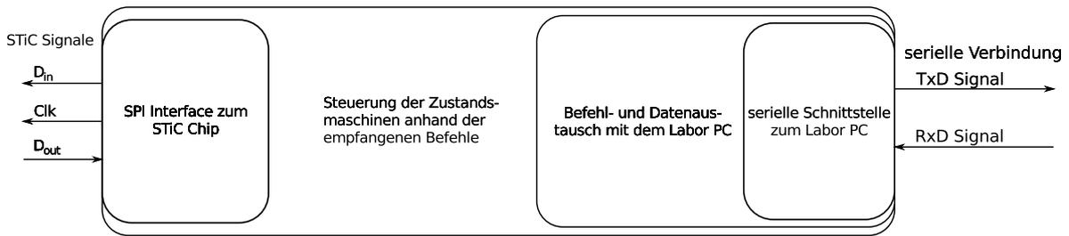
Abbildung 4.13: Diagramm der Zustandsmaschinen für die Übertragung einer Konfiguration
