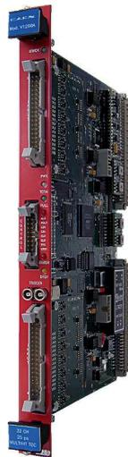
**Abbildung 5.5:** CAEN V1290A HPTDC Board für Zeitmessungen mit 25 ps Auflösung
