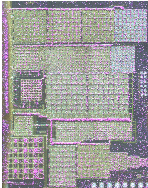
Abb. 8.4b: Gesamtansicht bei 20V Pixelspannung, 10V Gitterspannung (Versuch 30-11)
