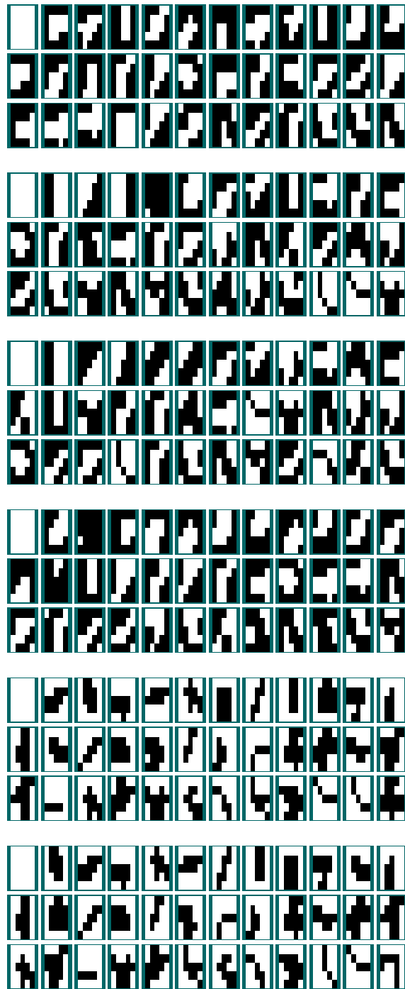
Abbildung A.4: Die vom Differenzselektor getroffene Auswahl für die Features der ersten Stufe. Der Trainingsdatensatz besteht dabei aus den ersten drei Bildern jeder Ziffer innerhalb der MNIST-Datenbank. Die Fokusbereichsgröße ist 5 \times 5 . Die Selektorparameter sind von oben nach unten: (p_4 = 0, 3; p_5 = 1; p_6 = 0, 15) , (p_4 = 0, 3; p_5 = 3; p_6 = 0, 15) , (p_4 = 0, 3; p_5 = 5; p_6 = 0, 15) , (p_4 = 0, 5; p_5 = 1; p_6 = 0, 15) , (p_4 = 0, 5; p_5 = 3; p_6 = 0, 15) , (p_4 = 0, 5; p_5 = 5; p_6 = 0, 15) .
