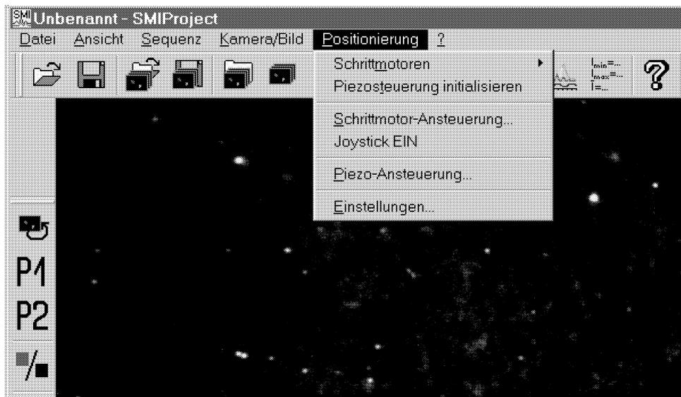
Abbildung B.16: Menü „Positionierung“ zum Aufrufen der Dialogfelder für die Schrittmotor- und Piezo-Steuerung. Außerdem können beide Steuerungen initialisiert, das z-Intervall der Schrittmotoren gesetzt (Menüpunkt „Schrittmotoren ⇒“) sowie ein Dialogfeld zum Ändern einiger Einstellungen aufgerufen werden.
