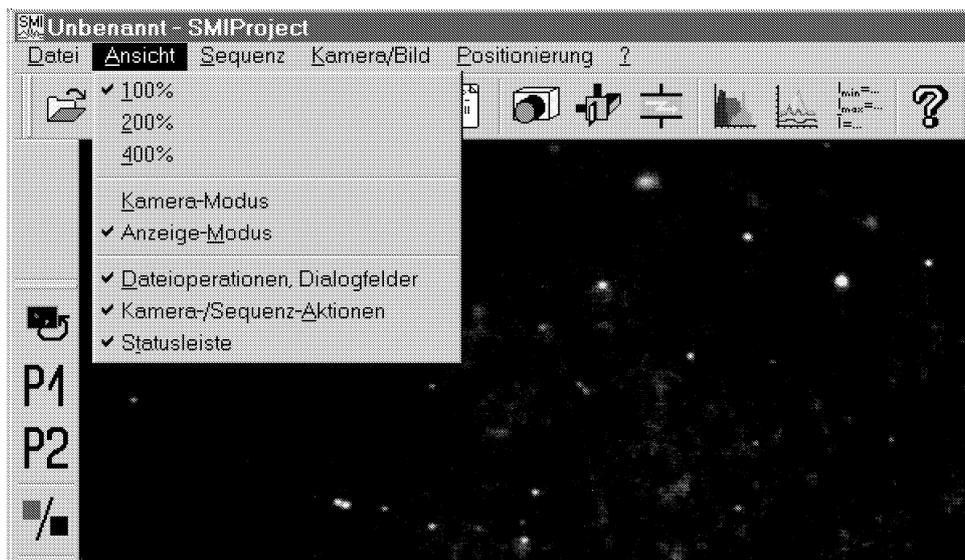
Abbildung B.6: Menü „Ansicht“. Hier kann die Bildgröße auf dem Hauptansichtsfenster geändert oder in einen anderen Programmmodus umgeschaltet werden. Außerdem kann man die Werkzeugleisten und die Statusleiste ein- bzw. ausblenden.
