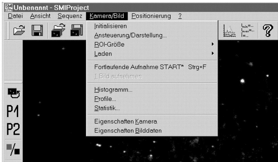
Abbildung B.10: Menü „Kamera/Bild“ zum Aufrufen des Dialogfelds für die Kamera-Ansteuerung und Darstellung der Bilddaten sowie für die Dialogfelder „Histogramm“, „Profile“ und „Statistik“. Außerdem können die wichtigsten CCD-Kamerafunktionen ausgelöst und die Eigenschaften von Kamera und Bilddaten angezeigt werden.
