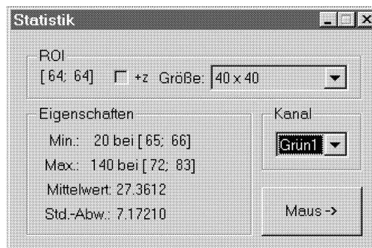
Abbildung B.15: Dialogfeld „Statistik“ (nicht-modal). Bezogen auf die ROI im Hauptansichtfenster werden der Minimal- und Maximalwert, das arithmetische Mittel sowie die Standard-Abweichung der Pixelintensitäten angezeigt.
