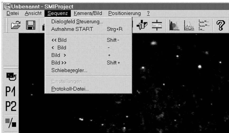
Abbildung B.7: Menü „Sequenz“ zum Einstellen der Parameter für die Sequenz-Aufnahme. Alle Menüpunkte außer „Schieberegler...“ sind auch über die Werkzeugleisten erreichbar.
