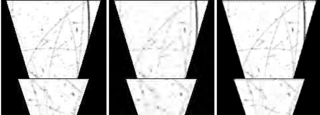
Abbildung 6.1: Decodierte Einzelbilder bei Kompressionsraten, die das Gesamtdatenvolumen auf etwa 30% reduzieren würden.
