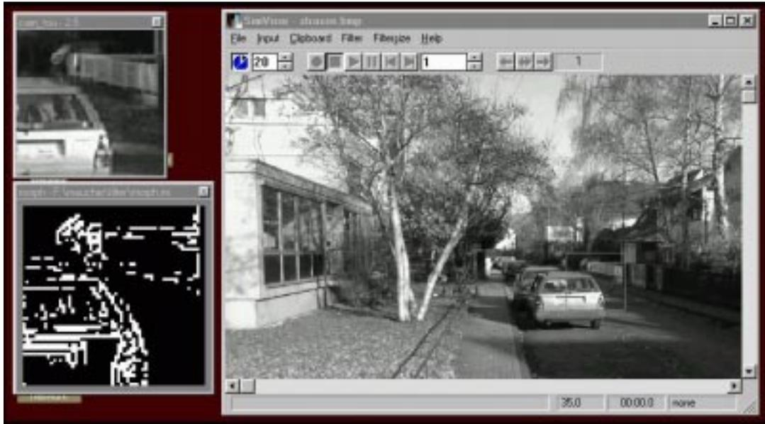
**Abbildung 3.12:** Die Abbildung zeigt die Funktion des *morphologischen Filters* bei dem das Ausgabebild gleich binarisiert wurde.
