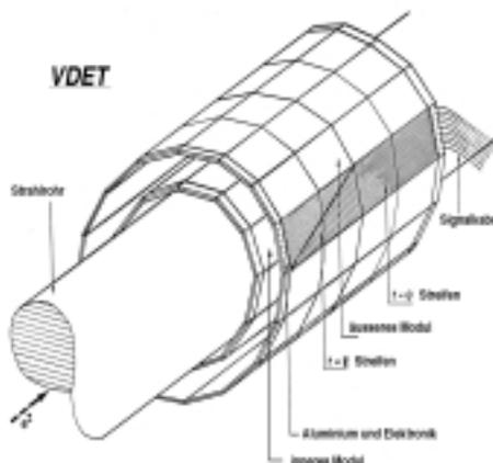
Abbildung 3.3: Schematische Darstellung des Vertexdetektors
