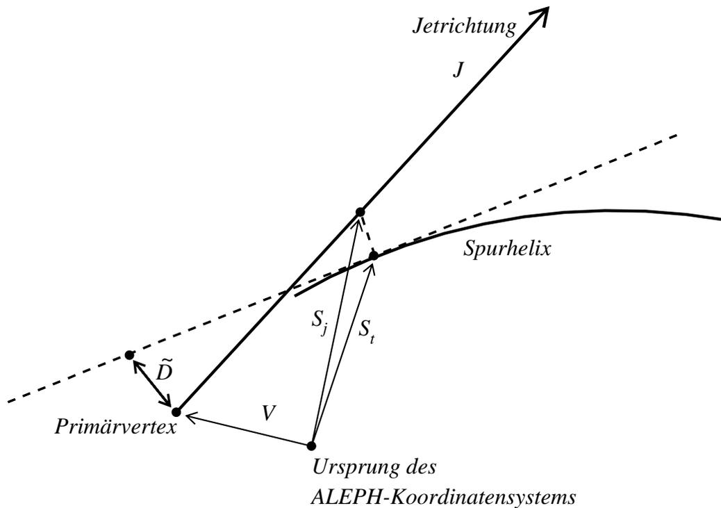
Abbildung 5.2: Schematische Darstellung der Definition des Impaktparameters. Man beachte die perspektivische Darstellung.
