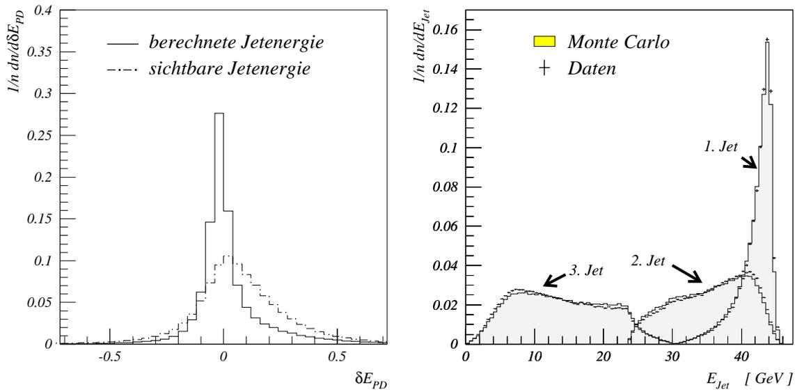
Abbildung 5.5: Verhalten der berechneten Jetenergien. Links ist  $\delta E_{PD}$  sowohl für die sichtbare Energie als auch für die berechnete Energie aufgetragen. Die Verbesserung der Energiebestimmung durch die Benutzung von Formel 5.1 ist deutlich zu erkennen. Rechts ein Vergleich von Daten und Monte Carlo für die berechnete Energie.
