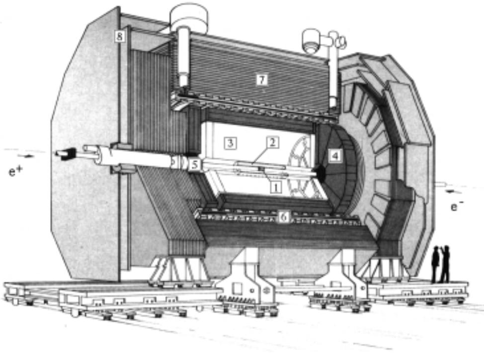
Abbildung 3.2: Darstellung der einzelnen Komponenten des Detektors ALEPH: 1. Vertexdetektor (VDET), 2. Innere Spurkammer (ITC), 3. Zeitprojektionskammer (TPC), 4. Kalorimeter für elektromagnetische Schauer (ECAL), 5. Luminositätskalorimeter (LCAL), 6. Magnetspule, 7. Hadronkalorimeter, 8. Myonkammern.
