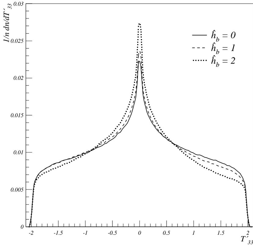
Abbildung 2.2:  $\langle T'_{33} \rangle$ -Verteilungen für verschiedene Werte von  $\hat{h}_b$ . Deutlich zu erkennen ist die Asymmetrie in den Flanken der Verteilung bei größeren Werten des Kopplungsparameters.
