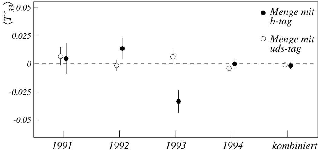
Abbildung 6.2: Vergleich der Mengen mit *uds-tag* und *b-tag* für die Daten der Jahre 1991-1994. Die Fehlerbalken decken nur den statistischen Fehler ( $1\sigma$ ) ab.
