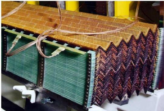
**Abbildung 3.5:** Die Akkordeonstruktur des elektromagnetischen Kalorimeters [20].
